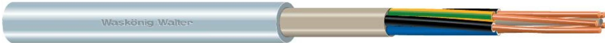
In Anlehnung an VDE 0250 Teil 204. Verlegung über, auf, im und unter Putz in trockenen, feuchten und nassen Räumen sowie im Mauerwerk und im Beton, ausgenommen für direkte Einbettung in Schüttel-, Rüttel- oder Stampfbeton. Auch für die Verwendung im Freien geeignet, sofern vor direkter Sonneneinstrahlung geschützt, jedoch nicht im Erdreich.
