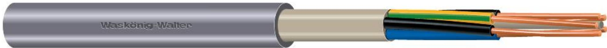
Nach VDE 0262. Zur festen Verlegung in trockenen, feuchten und nassen Räumen sowie im Mauerwerk und zur direkten Einbetonung in Schütt-, Rüttel- und Stampfbeton. Sie sind auch für die Verlegung im Freien geeignet. Sie dürfen nicht in Erde oder in Wasser verlegt werden. Hinweis: Bei Verdrahtung in Leuchten siehe unter Downloads "Verlegehinweise für Leitungen bzw. Kabel".
