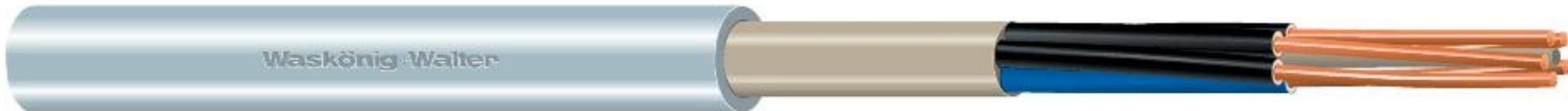
Nach VDE 0250 Teil 204. Verlegung über, auf, im und unter Putz in trockenen, feuchten und nassen Räumen sowie im Mauerwerk und im Beton, ausgenommen für direkte Einbettung in Schüttel-, Rüttel- oder Stampfbeton. Auch für die Verwendung im Freien geeignet, sofern vor direkter Sonneneinstrahlung geschützt, jedoch nicht im Erdreich. Hinweis: Bei Verdrahtung in Leuchten siehe unter Downloads "Verlegehinweise für Leitungen bzw. Kabel"
