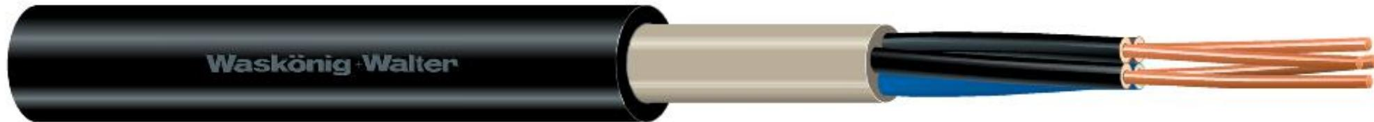
Conformément de la norme NF XP C 32-321. Pour une installation permanente dans les intérieurs, à l'extérieur et dans la terre. Lors du câblage dans une lumière rayonnante , dans laquelle la zone de rattachement du conducteur n 'est pas protégée contre le rayon ultraviolet et la charleur, un tube de protection doit être fondamentalement placé sur les fils conducteurs libres. Sinon, une décomposition de l'isolation peut survenir selon le facteur de marche.
