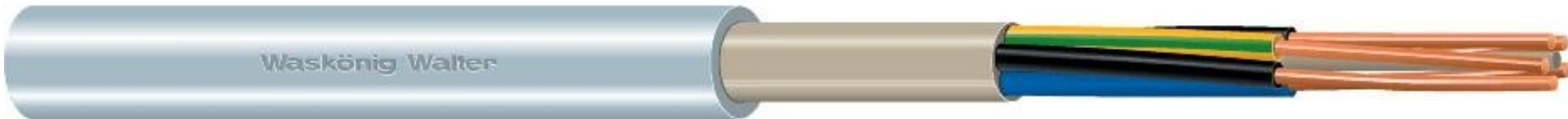
Nach VDE0250 Teil 214. Zur Verlegung über, auf, im und unter Putz, in trockenen, feuchten und nassen Räumen sowie im Mauerwerk und im Beton, ausgenommen für direkte Einbettung in Schüttel-, Rüttel- oder Stampfbeton; vorwiegend in Gebäuden mit hoher Personen- und/oder Sachwertkonzentration. Diese Leitungen sind auch für die Verwendung im Freien geeignet, sofern sie vor direkter Sonneneinstrahlung geschützt sind.
