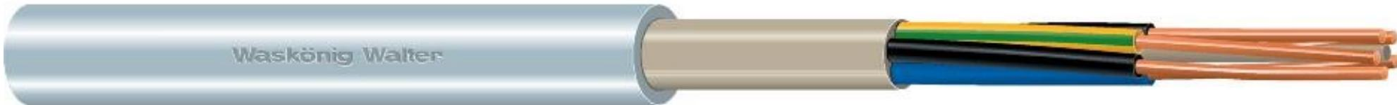
Nach VDE0250 Teil 214. Zur Verlegung über, auf, im und unter Putz, in trockenen, feuchten und nassen Räumen sowie im Mauerwerk und im Beton, ausgenommen für direkte Einbettung in Schüttel-, Rüttel- oder Stampfbeton; vorwiegend in Gebäuden mit hoher Personen- und/oder Sachwertkonzentration. Diese Leitungen sind auch für die Verwendung im Freien geeignet, sofern sie vor direkter Sonneneinstrahlung geschützt sind.
